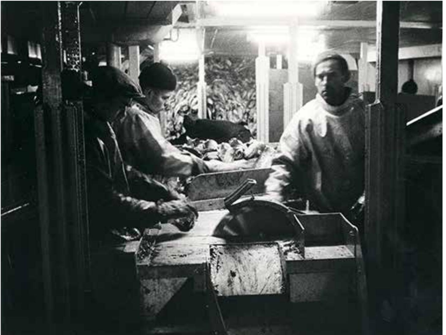
*Bild: Ein sogenanntes Fabrikschiff: schon an Bord wurde der Fisch verarbeitet und dann in Blöcken gefrostet.*
