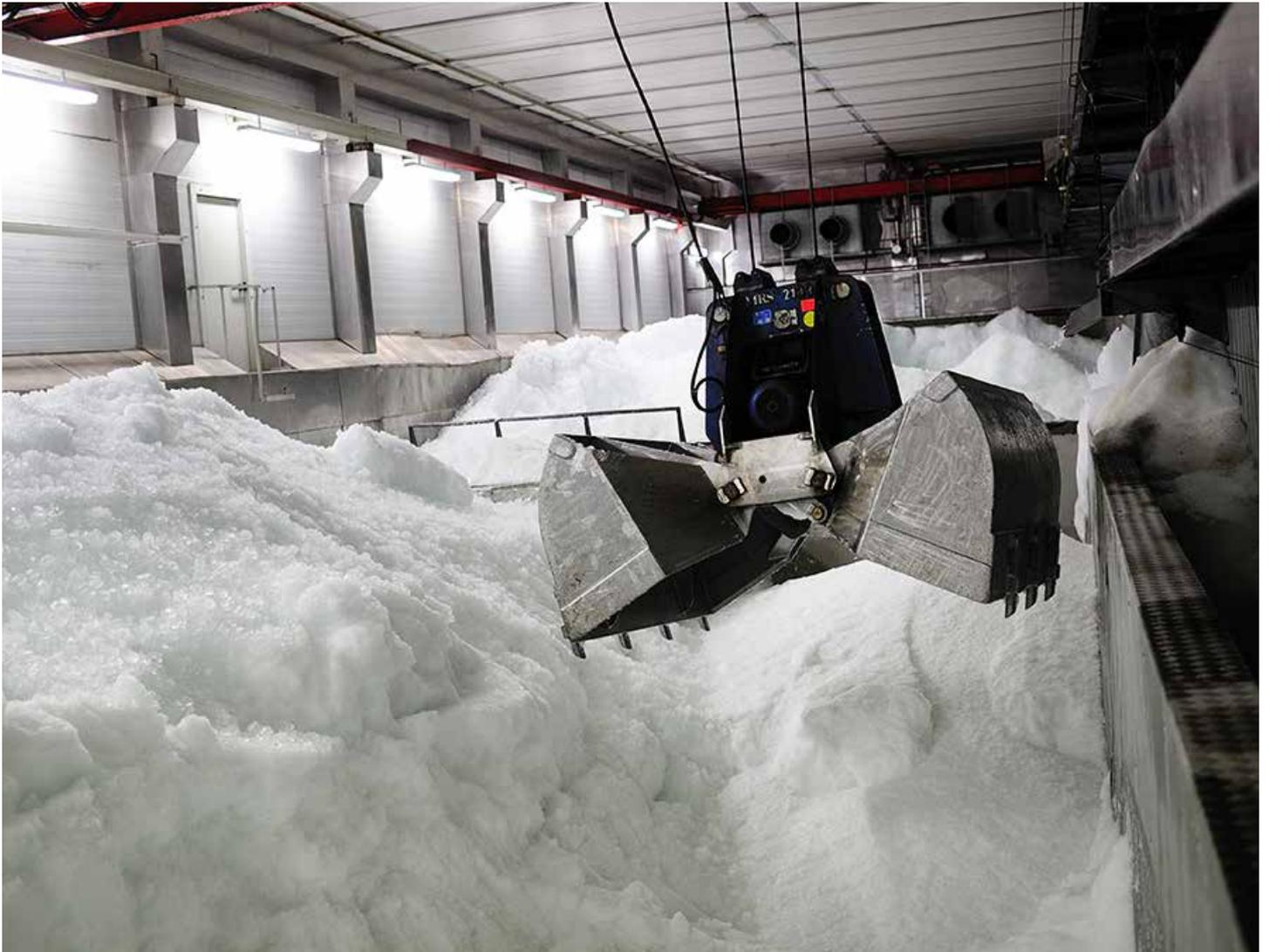
*Bild: Produktion und Verladung von Bruch- und Schütteeis*
